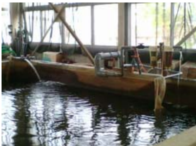
採卵用湖水の1,2次ろ過（1次は2種類のフィルターろ過、2次は循環ろ過）及びマイクロバブル処理
