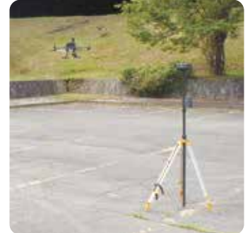
レーザードローンとGNSSモバイルステーション
